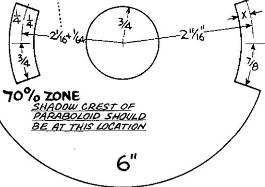
70% ZONE SHADOW CREST OF PARABOLOID SHOULD BE AT THIS LOCATION
