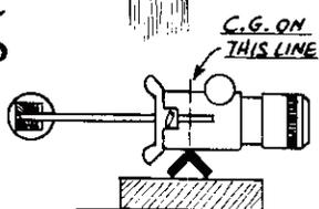
WEIGHT OF EYEPIECE IS AT SIDE OF TUBE
