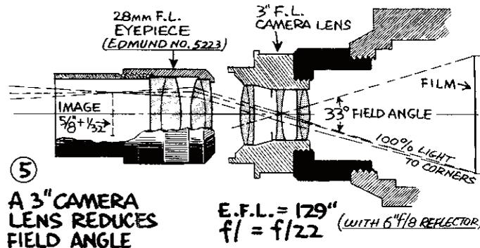
**A 3" CAMERA LENS REDUCES FIELD ANGLE**
