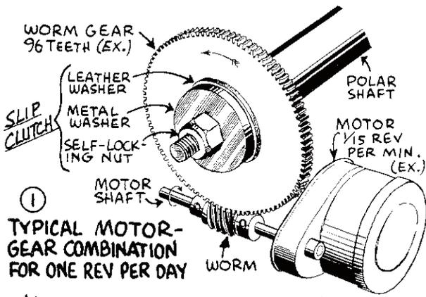
① TYPICAL MOTOR-GEAR COMBINATION FOR ONE REV PER DAY
