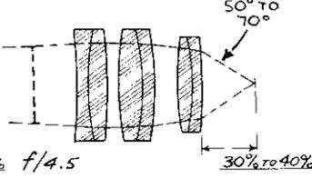
**ERFLE - DESIGNED ESPECIALLY FOR A WIDE FLAT FIELD. GOOD ASTRO EYEPIECE ALTHO MUCH OF THE DESIGN IS WASTED AT HI-POWER**
