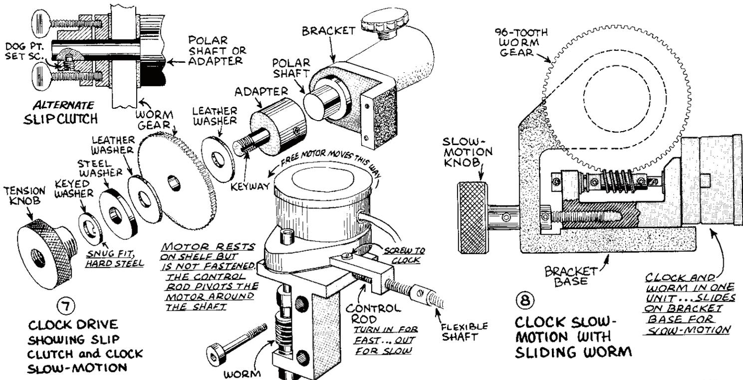
⑦ **CLOCK DRIVE SHOWING SLIP CLUTCH and CLOCK SLOW-MOTION**
