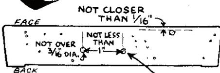
**BUBBLES** IN PYREX ARE A FAULT ONLY WHEN THEY SHOW ON SURFACE
