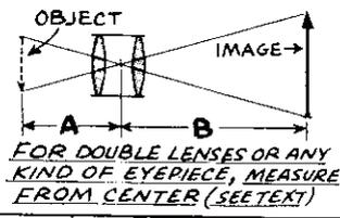
*EQUAL LENGTH OF PROJECTION LENS OR EYEPIECE*
