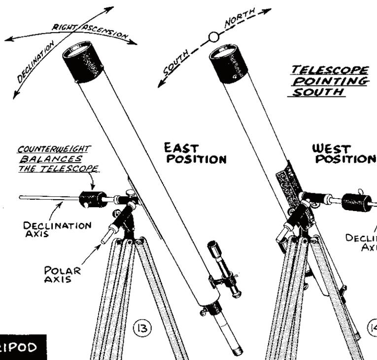
TELESCOPE CAN BE SWUNG TO EITHER SIDE OF TRIPOD
